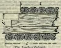
Fig. 3.-Log Culvert.
